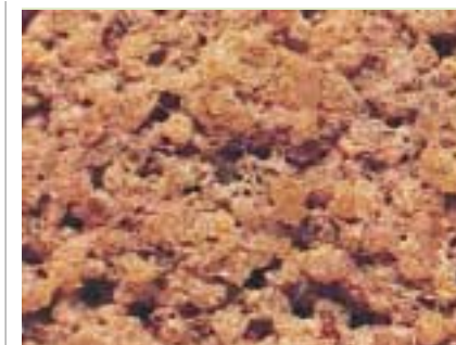
Bardziej porowata struktura zaprawy zawierającej domieszkę chemiczną (plastyfikator)
