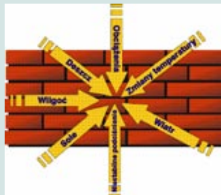
Destrukcyjne czynniki działające na konstrukcję mурową.
