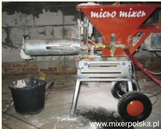
Zdjęcie 2. Zdjęcie dzięki uprzejmości firmy Mixer Polska z Wejherowa. Wydajność urządzenia: ok 1 tona wapna/godzina.
