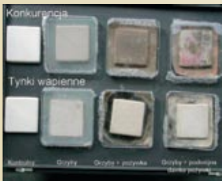
Fot. 1. Test tynków na odporność na korozję biologiczną.
